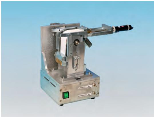
**Abb. 10** Labuda Rotations-Wischsimulator Mark III
